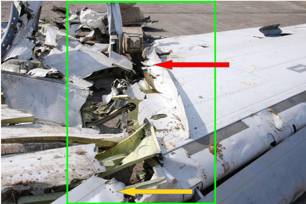
Zdjęcie DSC_0173, wykonane przez członków KBWLLP 19.04.2010 – strzałką żółtą pokazano poszarpany fragment slotu (przedniej krawędzi), strzałką czerwoną przecięcie tylnej części skrzydła
